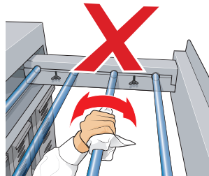
Figur 6 - Ikke vri kluten rundt røret. UV-røret kan da bli skadet
