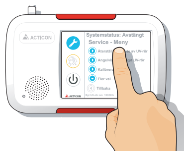
Figur 14 - Trykk "Resett etter bytte av UV-rør"
