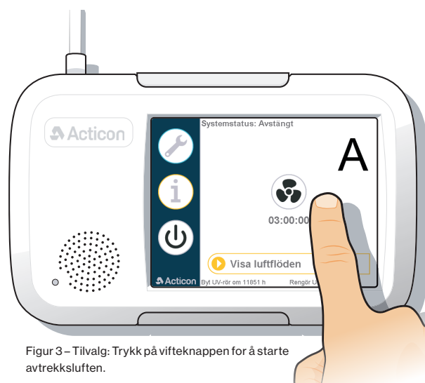
Figur 2 – Øverst på skjermen vises om systemet er i drift eller slått av. Nederst vises når det er på tide å bytte UV-rør samt rengjøre systemet. Tidsintervallet for rengjøring kan endres i infomenyen. Trykk på on/off-knappen for å starte og stoppe systemet.
