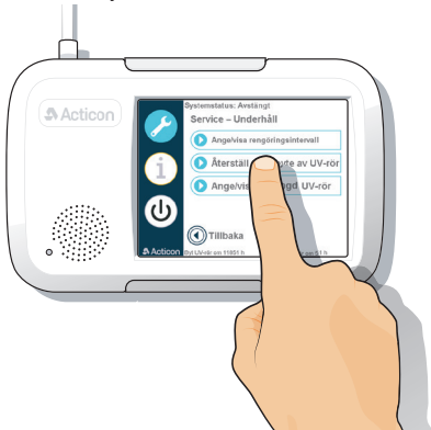
Figur 15 - Trykk "Resett etter bytte av UV-rør"
