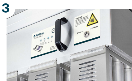
3. UV-lys og ozon dannes av lysrør plassert i filterhusets reaksjonskammer. Når luftstrømmen eksponeres for UV-lys og ozon, skjer en nedbrytning av gjenværende fett og luktstoffer.
